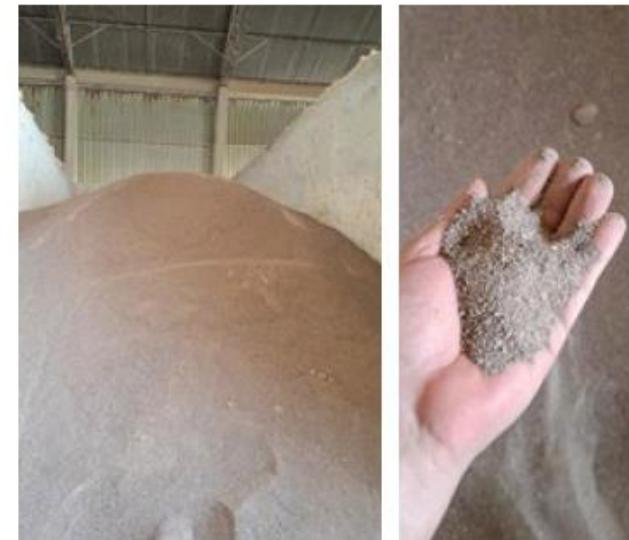
Quanto ao processo, após a Trituração externa, o ferro e outras impurezas são removidos, garantindo a redução da contaminação e dos rejeitos do projeto. Essa solução foi estendida a todos os fornos, tornando-se padrão na unidade. A substituição reduziu em 80% os custos associados à extração, transporte e processamento de areia virgem.
